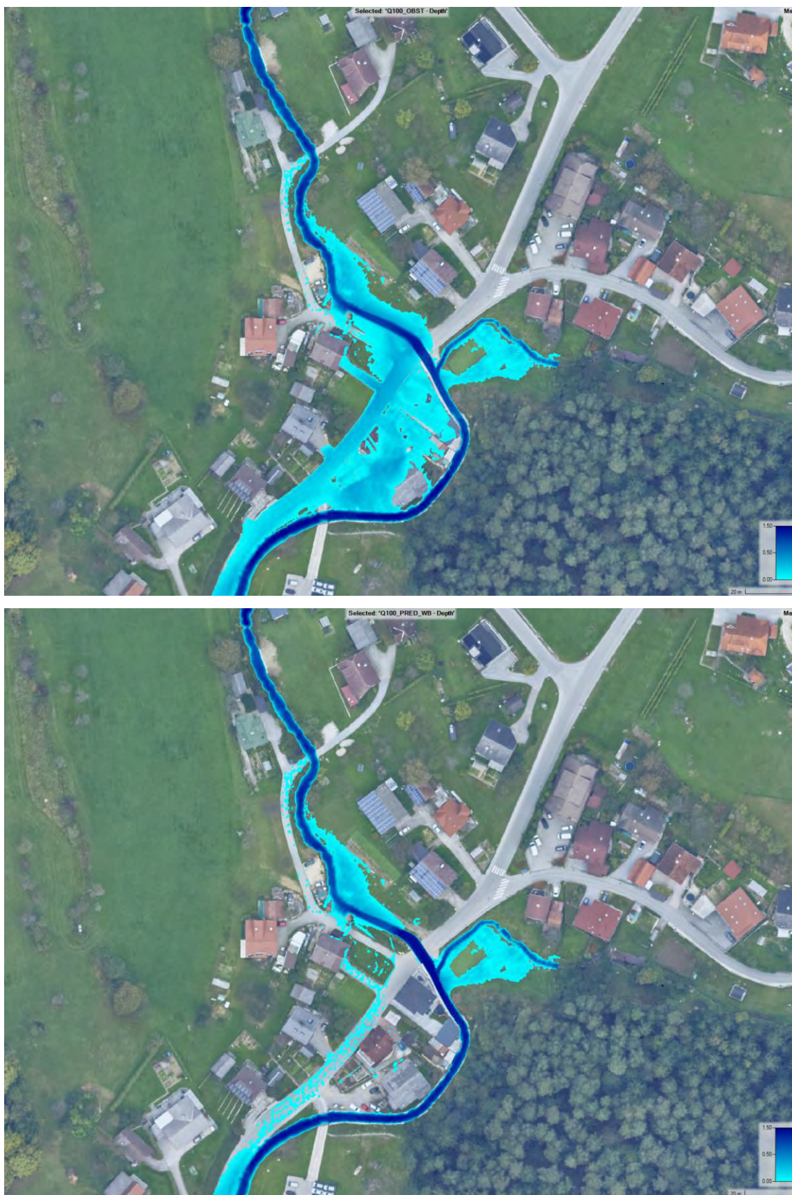
Slika 8: Primerjava dosega poplavnih vod za pretoke Q100 – zgoraj obstoječe stanje in spodaj predvideno stanje.
