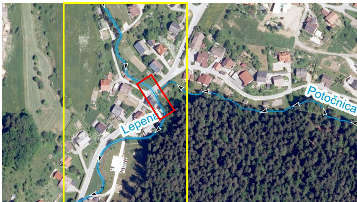
Slika 1: Prikaz območja obdelave (rdeče) in meje hidravličnega modela (rumeno).
